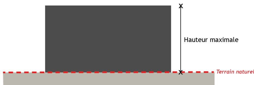
Calcul de la hauteur en fonction de la configuration du terrain
